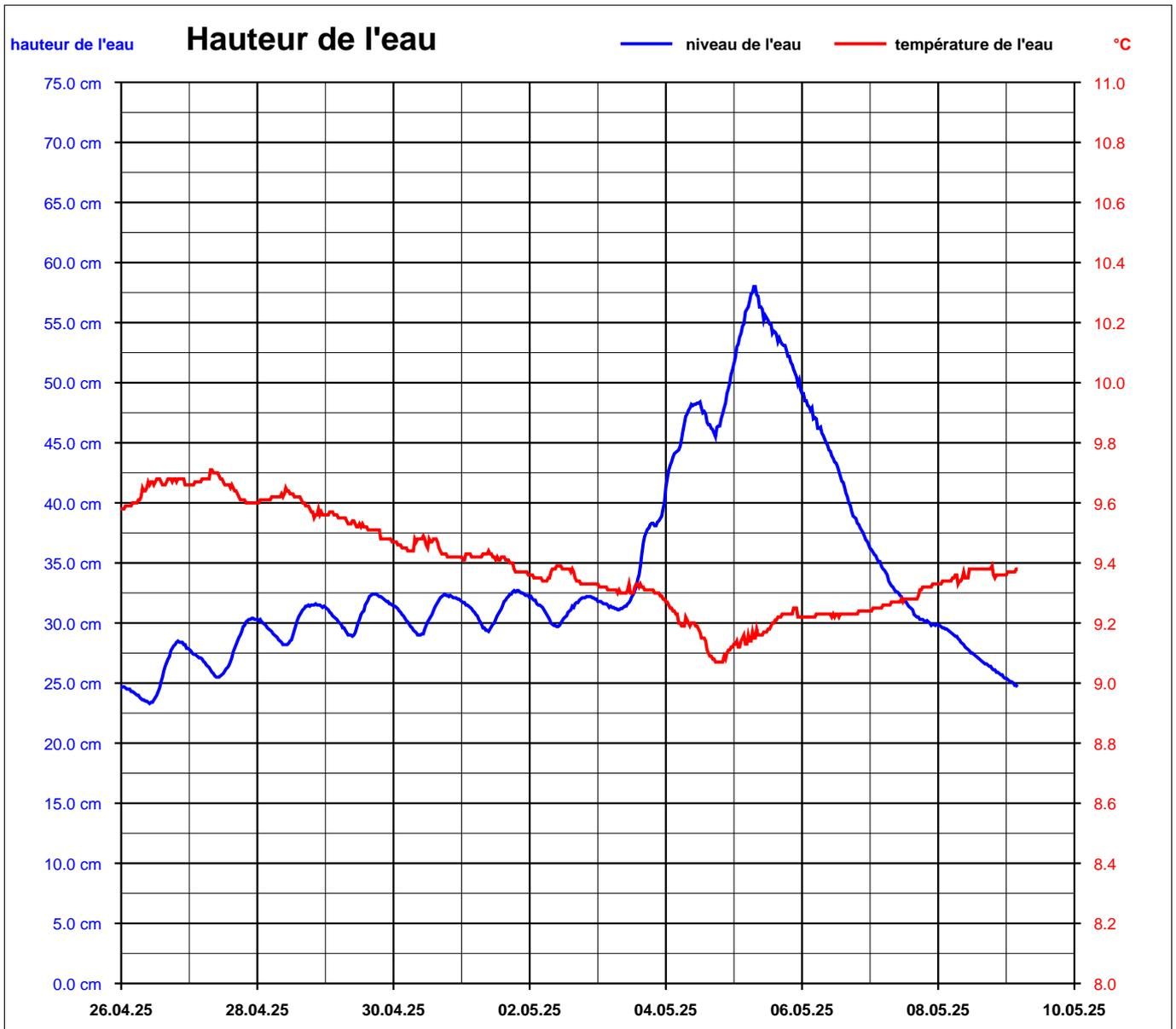
La station mesure la hauteur de l'eau et la température à la source
