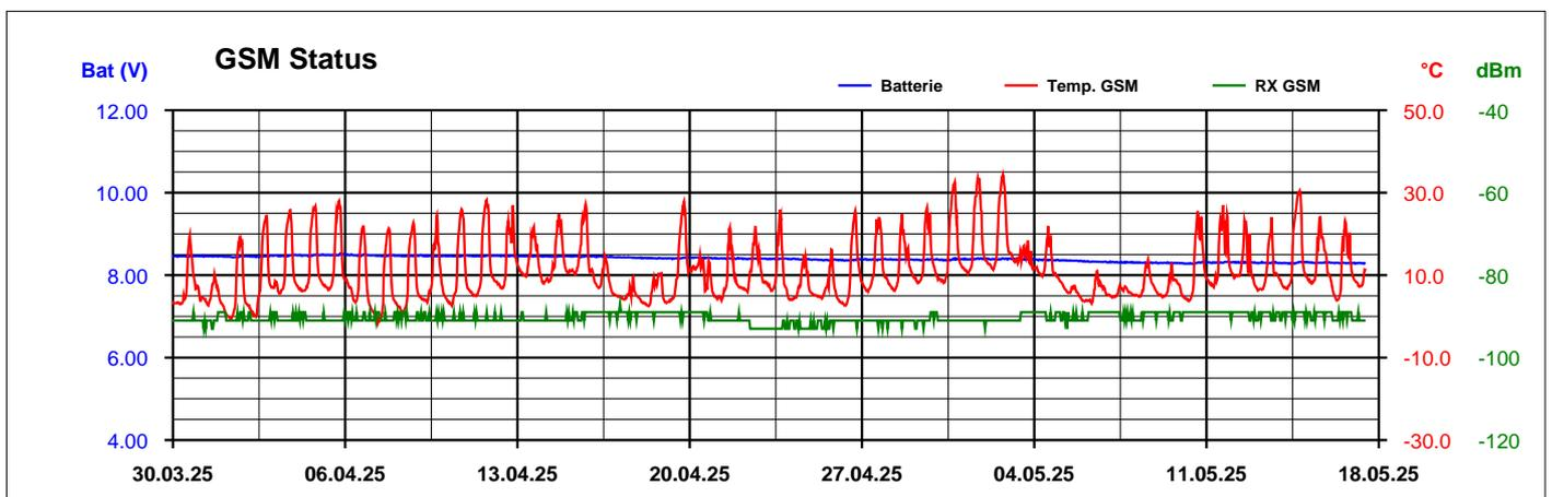
Bei jeder Uebermittlung wird auch die Batteriespannung, die Temperatur im GSM Modul und der Empfangspegel gemeldet. Zur Stromversorgung werden 6 LR20 Zellen verwendet. Sie müssen bei ca. 6V ersetzt werden. (ca. alle 2 Jahre)
