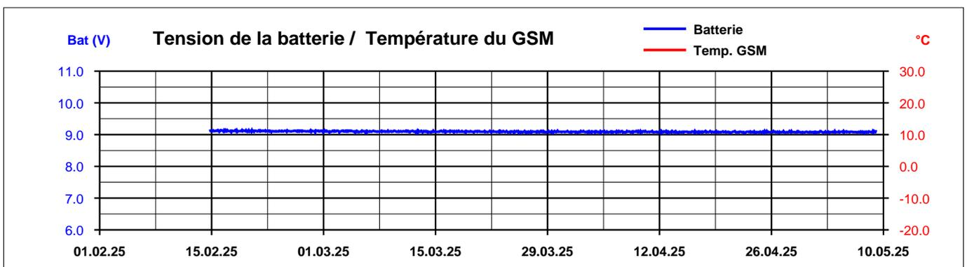
Lors de chaque mesure, la tension des batteries est transmise. Il s'agit de cellules 8-D. Elles devront être remplacées à un niveau de 10 volt. Dans le module GSM, la température est mesurée chaque 30 minutes.
