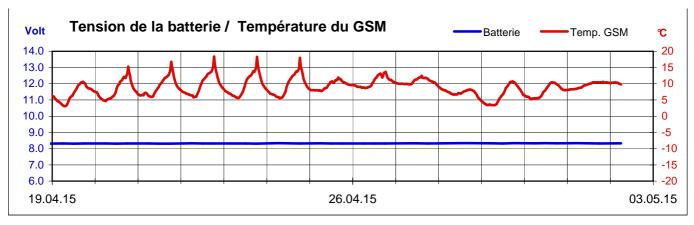
Lors de chaque mesure, la tension des batteries est transmise. Il s'agit de cellules 8-D. Elles devront être remplacées à un niveau de 10 volt environ. Dans le module GSM, la température est mesurée chaque 30 minutes.
