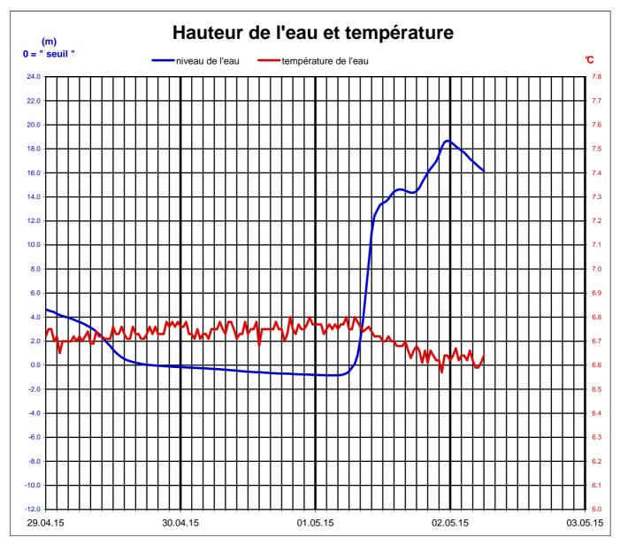
La station mesure la hauteur de l'eau au siphon. La sonde est reliée l'extérieur par un câble à deux conducteurs d'environ 500 m. Un GSM à l'entrée assure la transmission sur internet et l'interrogation de la sonde.
