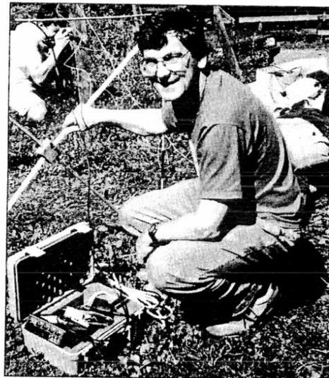
Ian Drummond (VE6IXD) mit dem kanadischen Höhlenfunkgerät am Messstandort Pragerstrasse. Das Loop-Antennensystem erlaubte keine Verbindung über die 266-m-Messstrecke, führte aber zu aufschlussreichen Vergleichen zwischen Erdstrom- und induktiver Signalübertragung.
